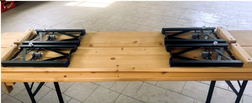
Bänke parallel ausrichten; Abstand zwischen den Bänken: 5-10 mm.
